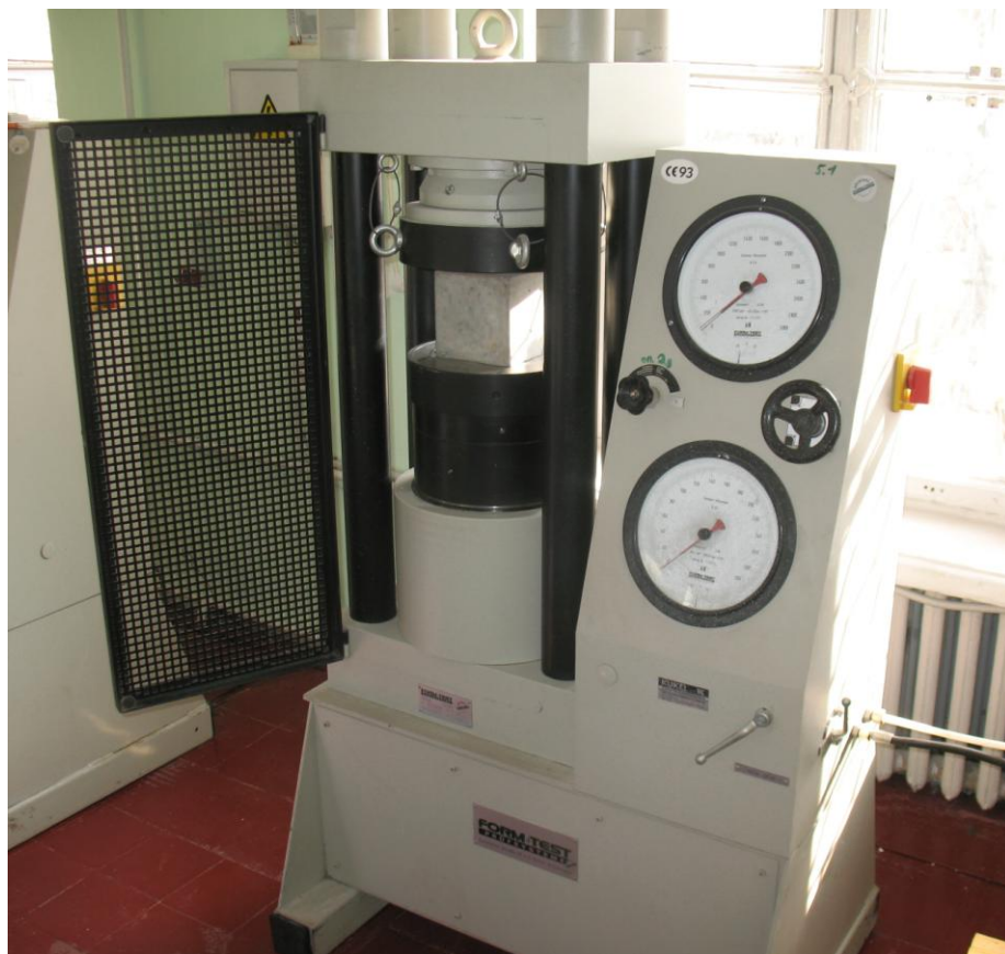
Прес 506/600M, виробництва Німеччина Максимальне зусилля – 600 кН
