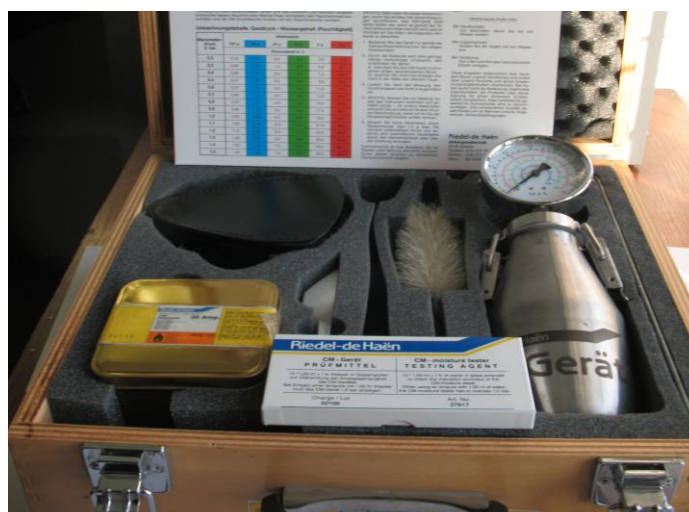
CM Tester для визначення вологовмісткості будівельних матеріалів
