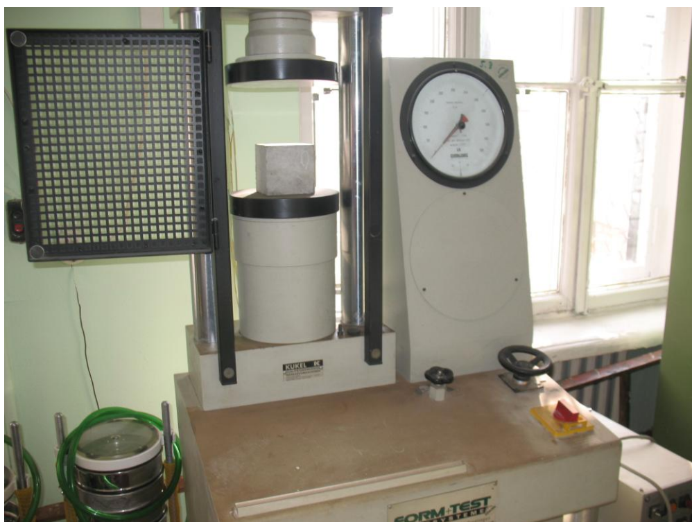
Прес 506/600M, виробництва Німеччина Максимальне зусилля – 600 кН
