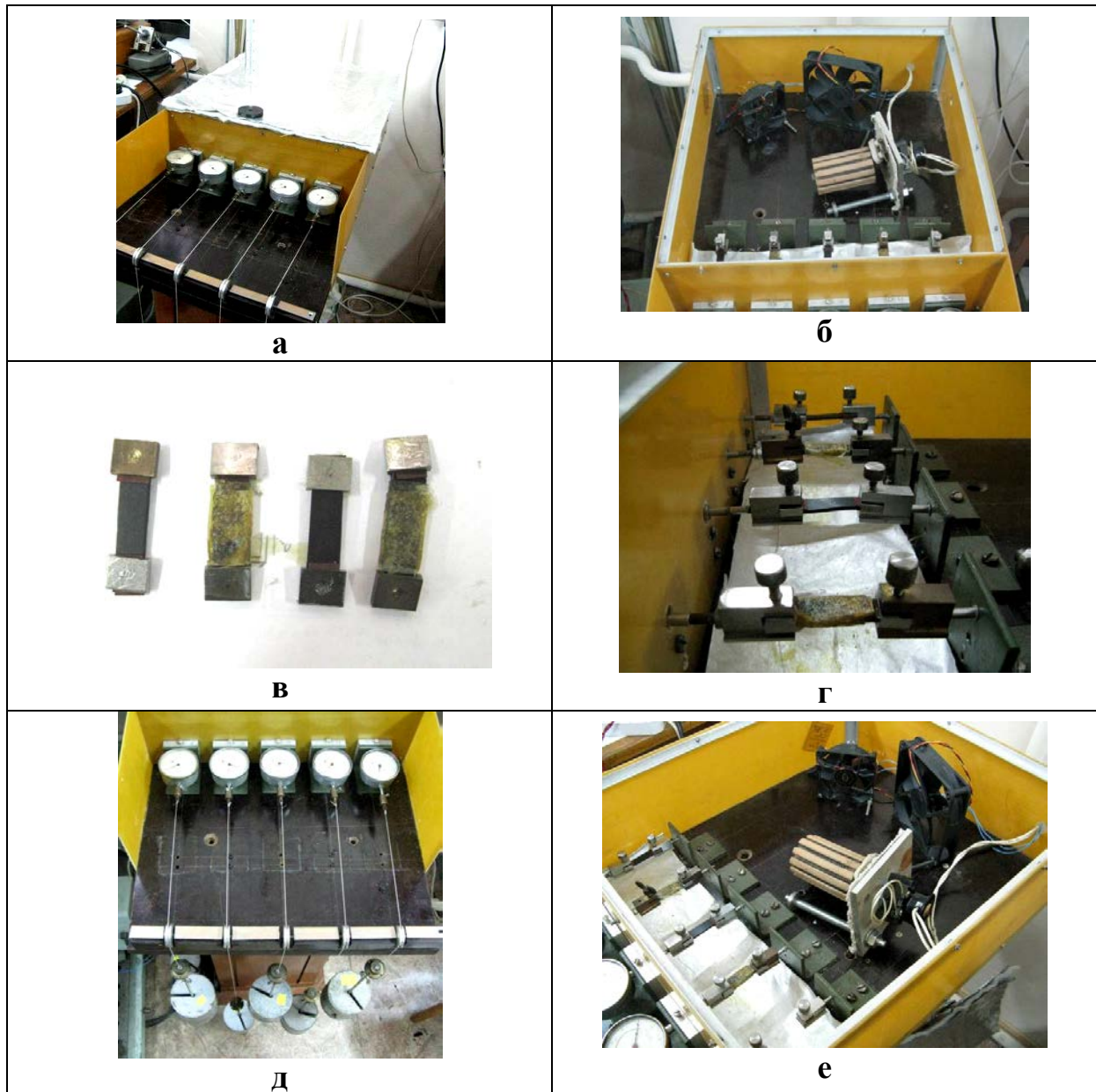
Рис. 2.8. Установа для вимірювання деформації повзучості плівкових та листових полімерних матеріалів: загальний вигляд установки (а), робоча камера (б), випробувальні зразки (в), зразки у затискувачах (г), системи навантаження та вимірювання деформацій зразків (д), система нагріву (е)
