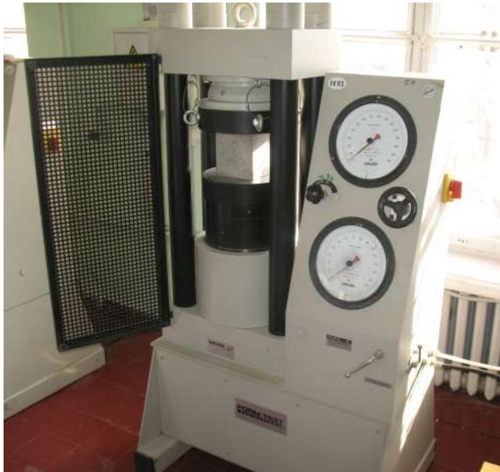
Прес 102E3000М (рік виготовлення – 1993, лабораторія механічних випробувань 166г)
