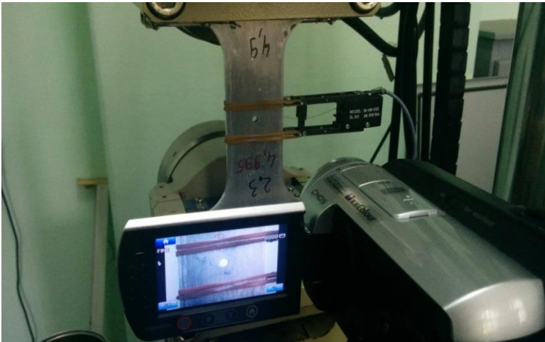
Рис. 2. Запис на відеокамеру процесу циклічного деформування зразку з отвором
