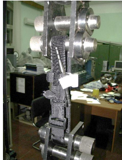
Рис. 5. Випробування зразків турнікету на розрив
