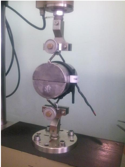
Рис. 4. Випробування зразків турнікету на повзучість
