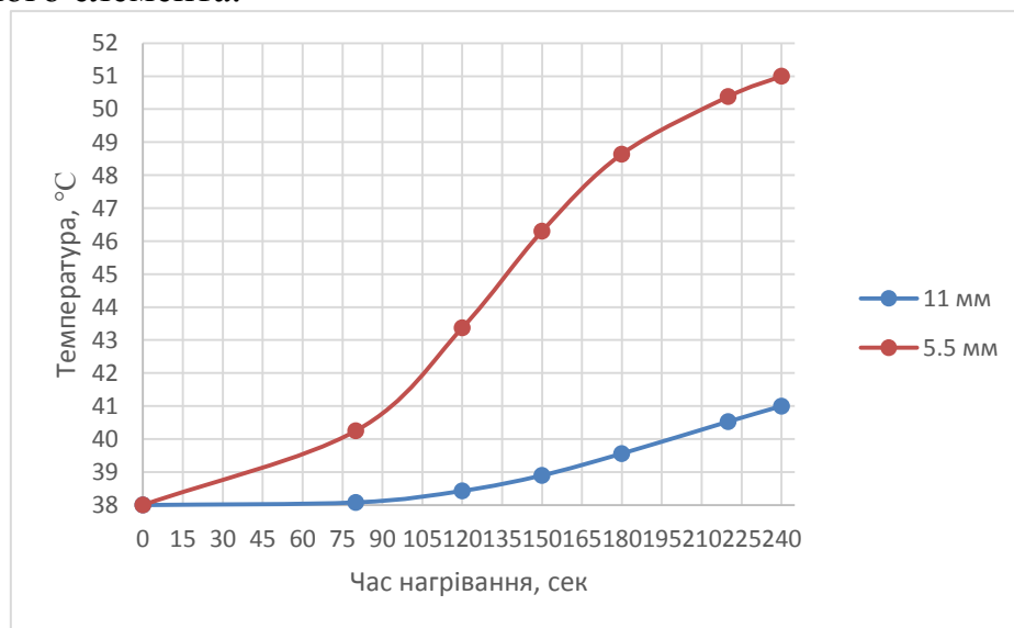
Рис.4. Залежність температури тканин печінки від часу нагрівання для двох точок: 5,5 мм та 11 мм від краю електроду
