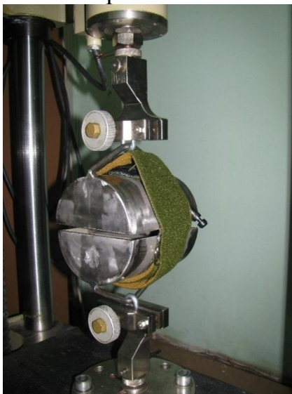
Рис. 1. Зовнішній вигляд робочої частини установки для випробувань зразків турнікету на здатність довготривалого утримування навантаження
