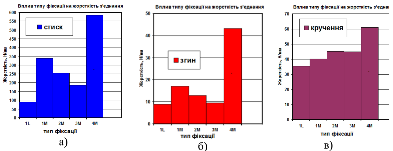
Рис. 2. Жорсткості фіксації великогомілкових кісток різними способами при стиску (а), згині (б) та крученні (в)
