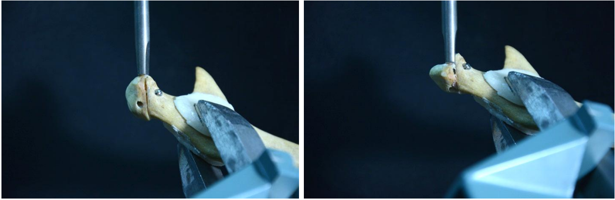
Рис. 3. Руйнування системи фіксатор-кістка при навантаженні зсувом
