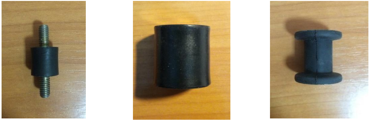
Рис. 2. Зразки пружних опор діаметрами 14,5 мм, 19,5 мм, 17 мм та довжиною 14,5 мм, 25 мм та 20 мм, відповідно
