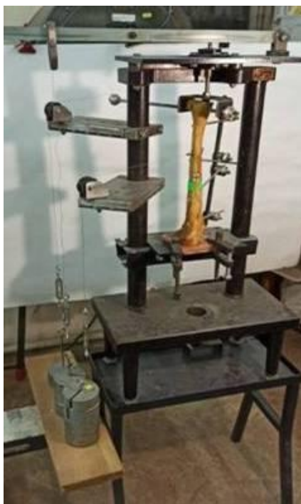
Установка для дослідження надійності фіксації переломів кісток
