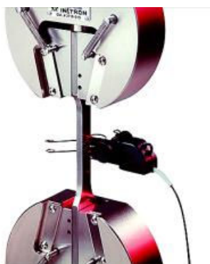
Рис. 6.8. Навісний тензометр виробництва фірми INSTRON
