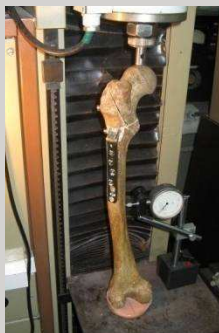
УСЕРЕДНЕНІ ЗНАЧЕННЯ ПЕРЕМІЩЕНЬ ТОЧОК СТЕГНОВОЇ КІСТКИ ФІКСОВАНОЇ ПЛАСТИНОЮ 130
