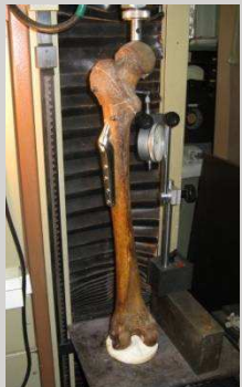
УСЕРЕДНЕНІ ЗНАЧЕННЯ ПЕРЕМІЩЕНЬ ТОЧОК СТЕГНОВОЇ КІСТКИ ФІКСОВАНОЇ ПЛАСТИНОЮ 130
