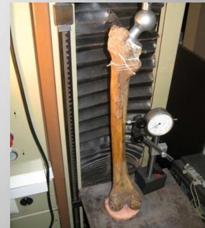
Випробування на стиск препаратів
