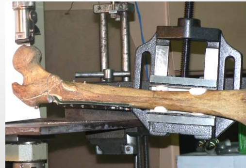
Випробування на згин препаратів
