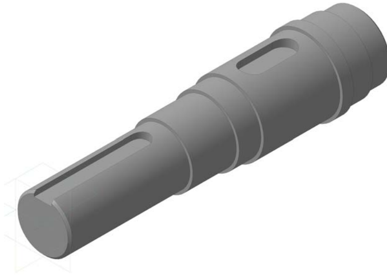
Рис. 10. Ступінчата форма вала
