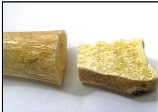
Рис. 1. Кістки кінцівок, з яких виготовляли зразки для випробувань
