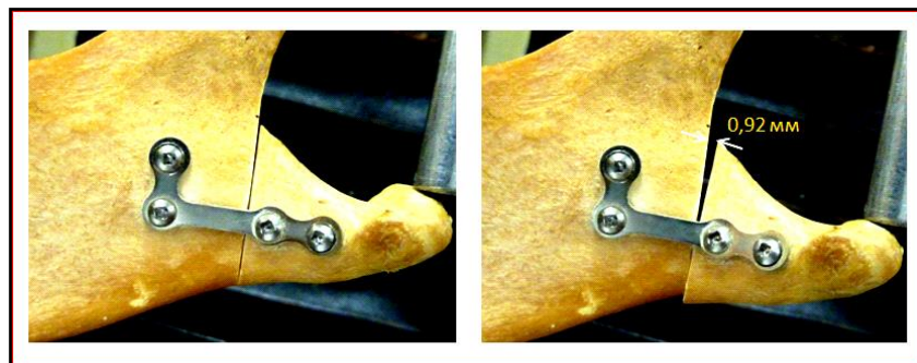
Рис. 2. Деформація системи фіксатор-кістка в умовах сагітального згину із зусиллям 25 Н
