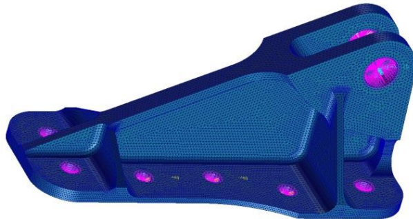
Рис.1 Кронштейн керма висоти: скінченно-елементна модель
