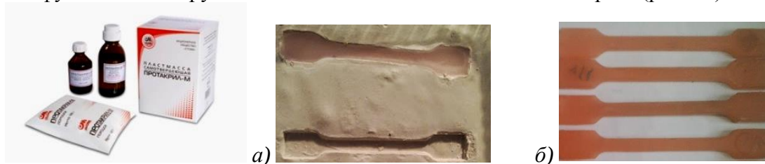
Рис. 1. Компоненти пластмаси (а), заливка пластмаси у форми (б), готові зразки (в)
