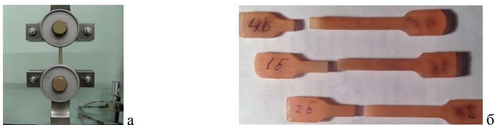
Рис. 1. Зразок пластмаси Протакрил-М під час випробувань (а) та вид зразків після руйнування (б)
