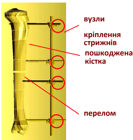
Рис. 1. Конструкція стрижневого апарата фіксації перелому кісток
