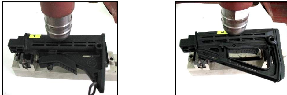
Рис. 1. Компоненти стрілецької зброї під час випробувань на удар
