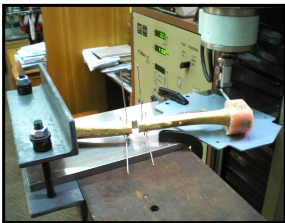
Рис. 1. Випробування ВГК при крученні
