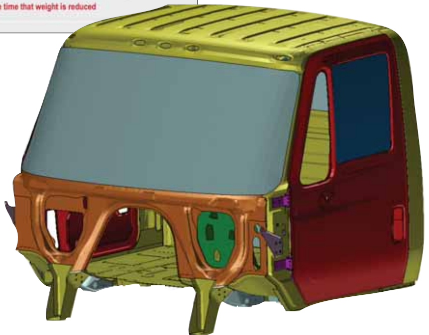
Рис. 4. Модель кабины магистрального тягача Navistar Heavy Duty Track
