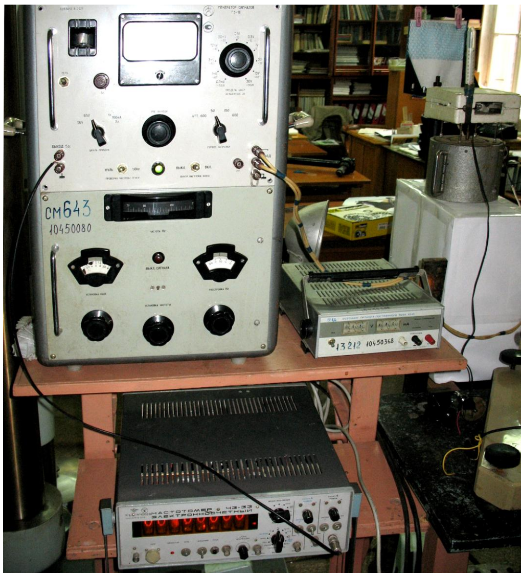
Фото 1. Загальний вигляд установки для дослідження впливу температури на динамічні властивості пластмас
