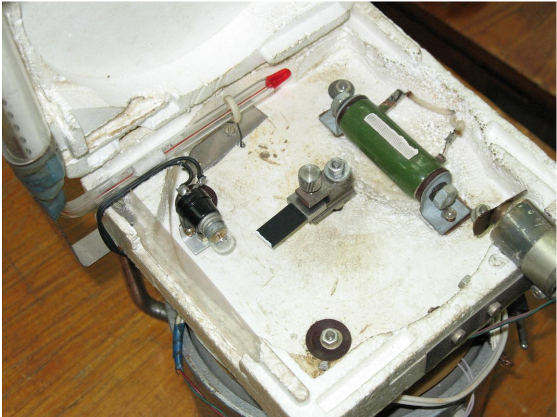
Фото 2. Температурна камера для проведення випробувань при підвищених та знижених температурах.
