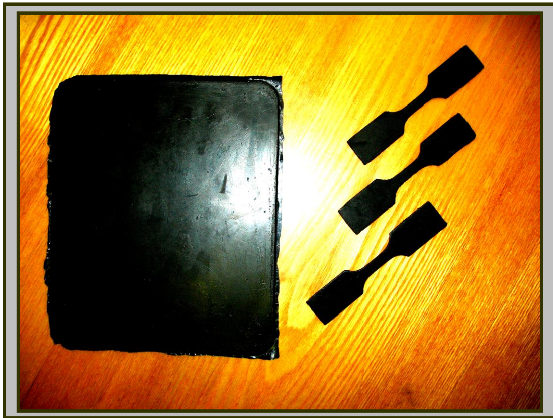
Рис. 6. Гумова пластина та зразки, виготовлені за стандартом [17], для випробувань на розтяг
