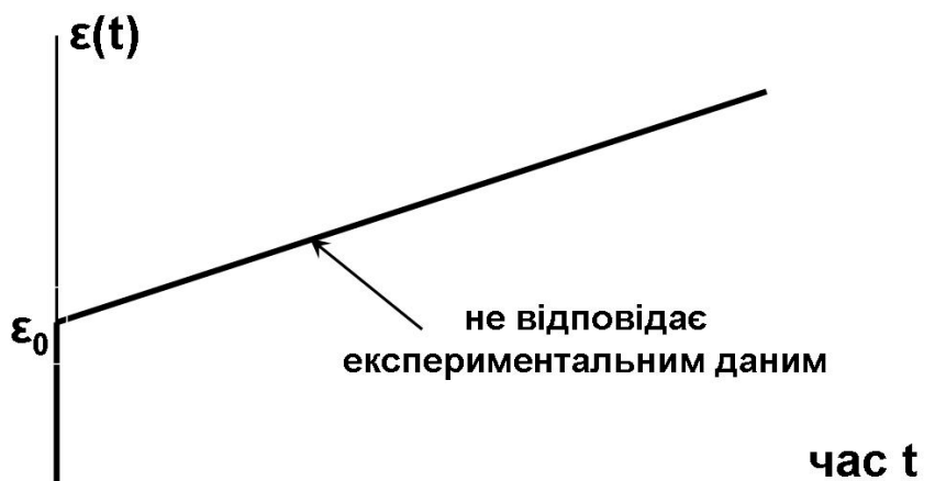
Рис. 3.9 -- Крива повзучості за моделлю Максвелла
