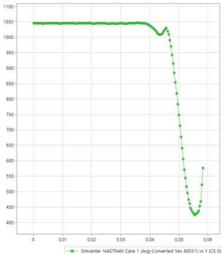
Рисунок 5.3. Графік розподілу еквівалентних за Мізесом напружень, МПа вздовж робочої довжини та заокруглення зразка
