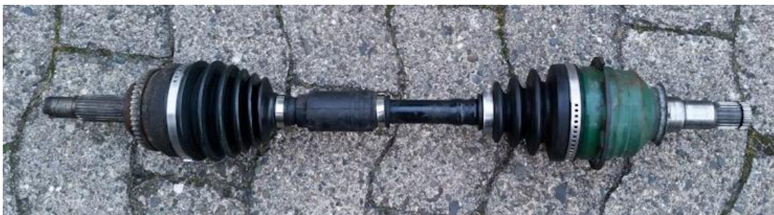
Рисунок 9: Приклад напівосі у зібраному вигляді
