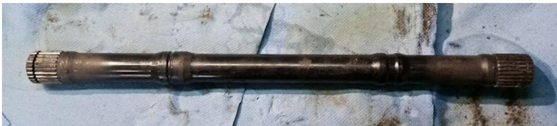
Рисунок 11: Приклад проміжного валу-напіввісі у розібраному вигляді
