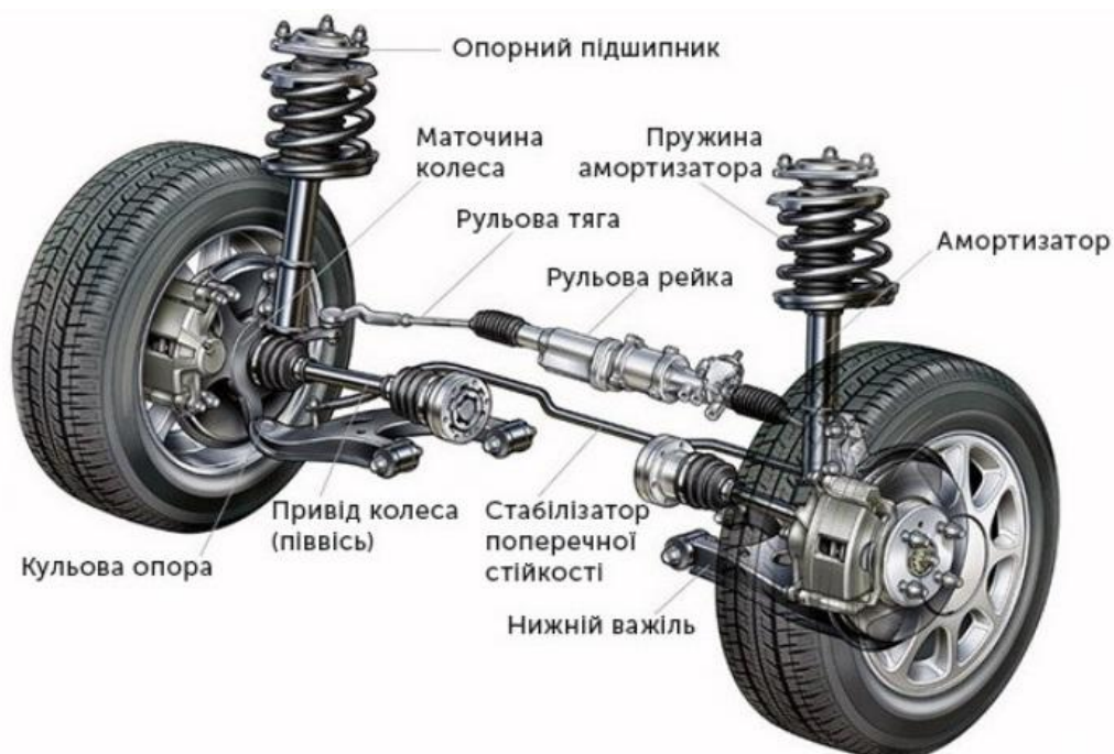
Рисунок 2: Загальна компоновка підвіски типу МакФерсон
