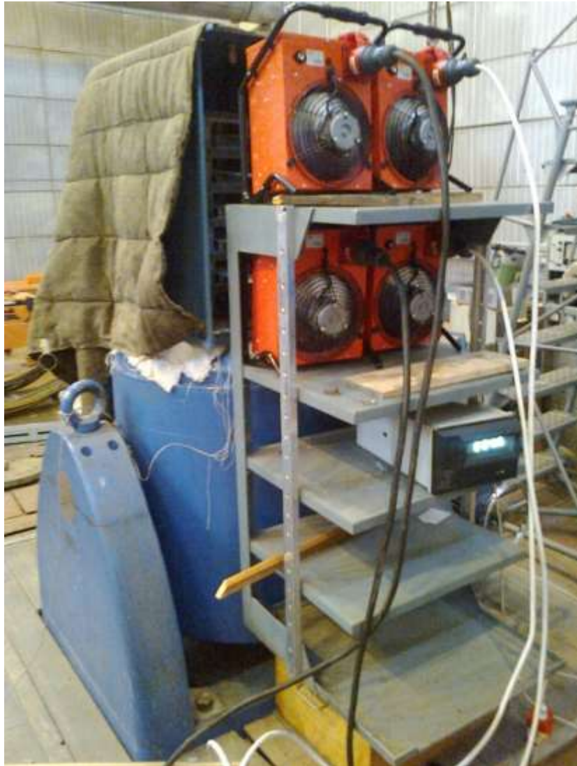
Рис. 7.2. Установка для створення температури 80 \pm 10 \text{ }^\circ\text{C}
