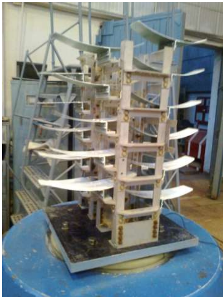
Рис. 7.1. Встановлення зразків на вібростенді
