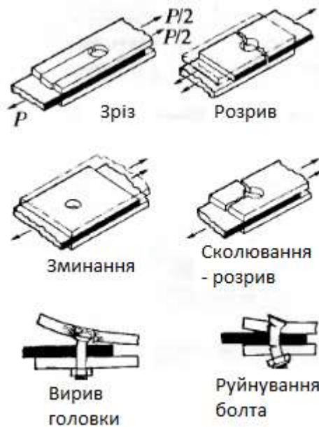
Рисунок 4.3 – Форми руйнування механічних з'єднань композитних матеріалів [4]
