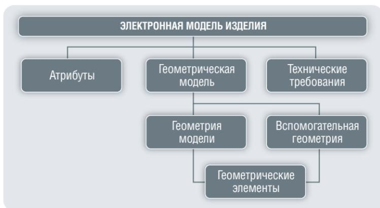
Рис. 3.2.3. Пример типового состава электронной модели изделия
