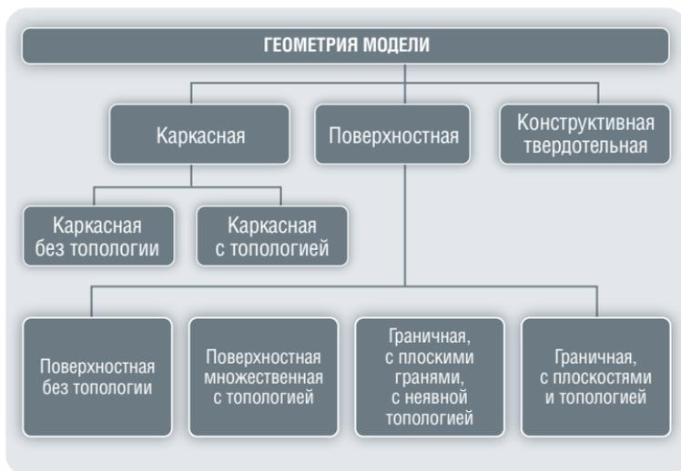
Рис. 3.2.4. Состав геометрической электронной модели изделия
