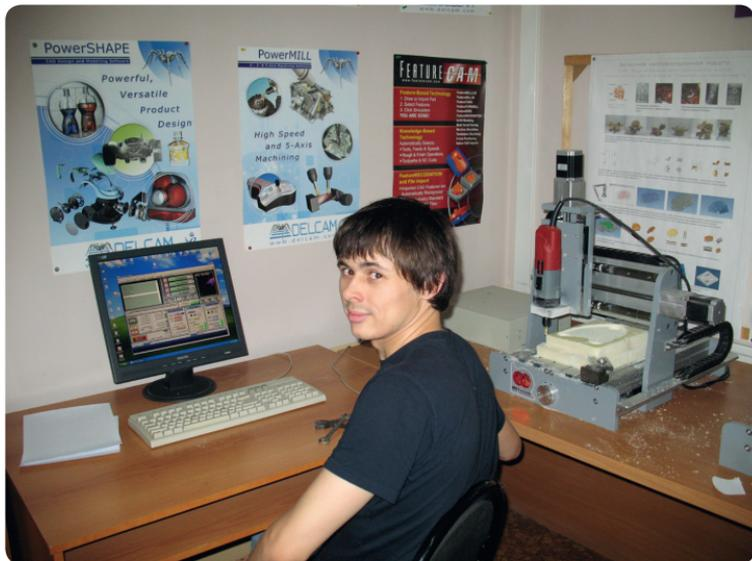
Рис. 4.30. Автоматизированное рабочее место обучаемого в УНВП на этапе разработки программ для обрабатывающего оборудования с ЧПУ
