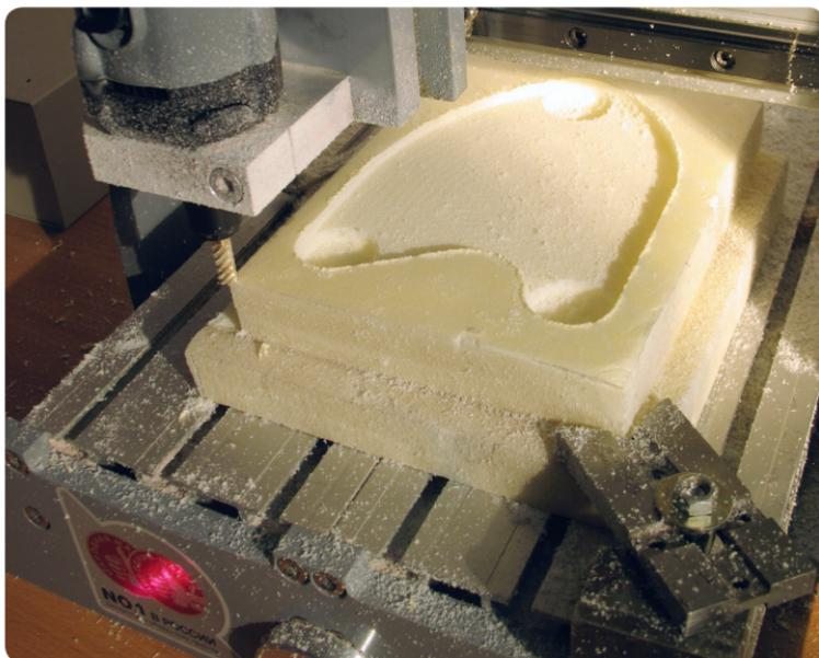
Рис. 4.32. Обработка на вертикально-фрезерном станке с ЧПУ макета технологической оснастки для изготовления детали горячей штамповкой
