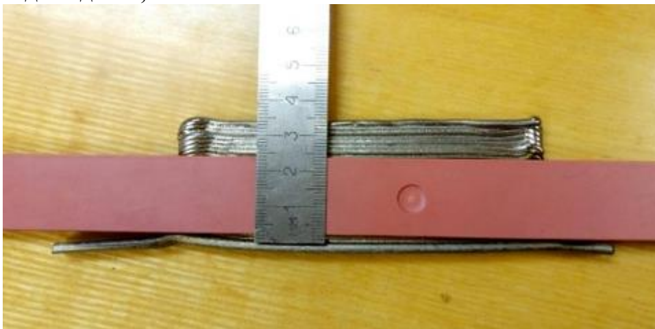
Рис. 24. Оцінений залишковий прогин експериментального зразка з малою підкладкою, мм.
