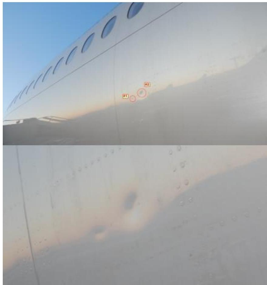
Рисунок 1-2 Приклад ум'ятин на фюзеляжі літака
